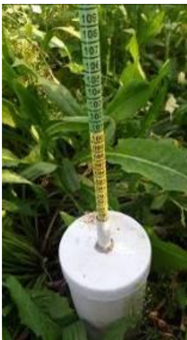
Figura 2: Freatímetro con flotante y varilla graduada, móvil a colores.
