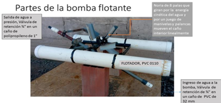
Figura 3: Partes de la bomba flotante.
