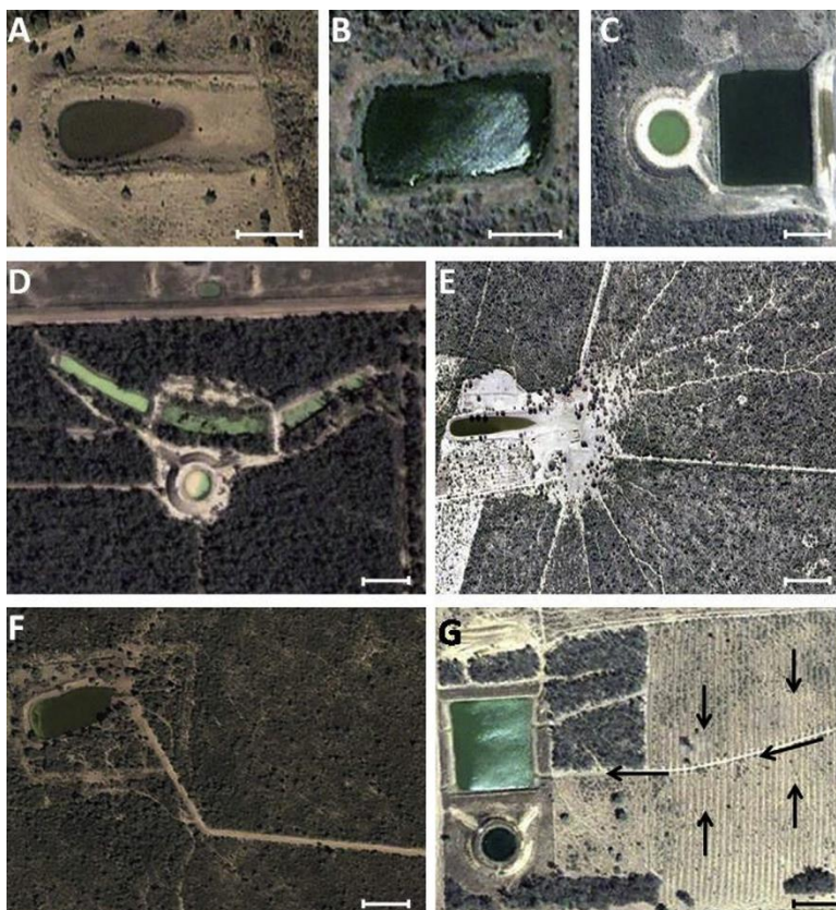
Figura 2: Represa de tipo herradura (A, típica para San Luís), “rectangular” (B) y compuesta (C, típicas para Paraguay). Áreas de captación tipo “paleocauces” (D), “senderos” de animales (E), “caminos” vehiculares (F) y “áreas dedicadas” (G); las flechas indican la dirección del escurrimiento). Barras horizontales: 50 m.
