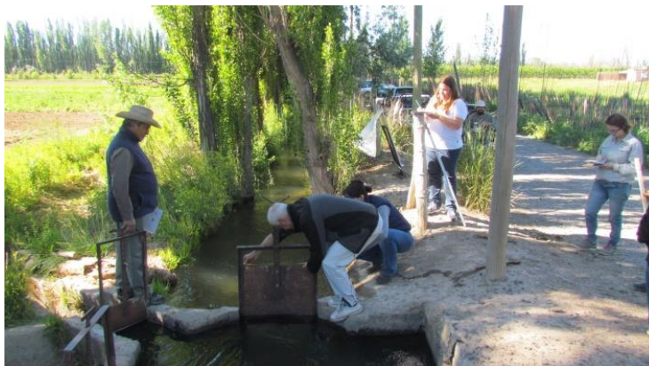
Figura 22: Practica de aforo en compuerta
