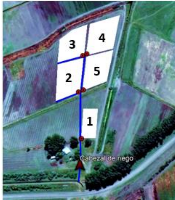
Figura 2. Esquema general del sistema de riego
