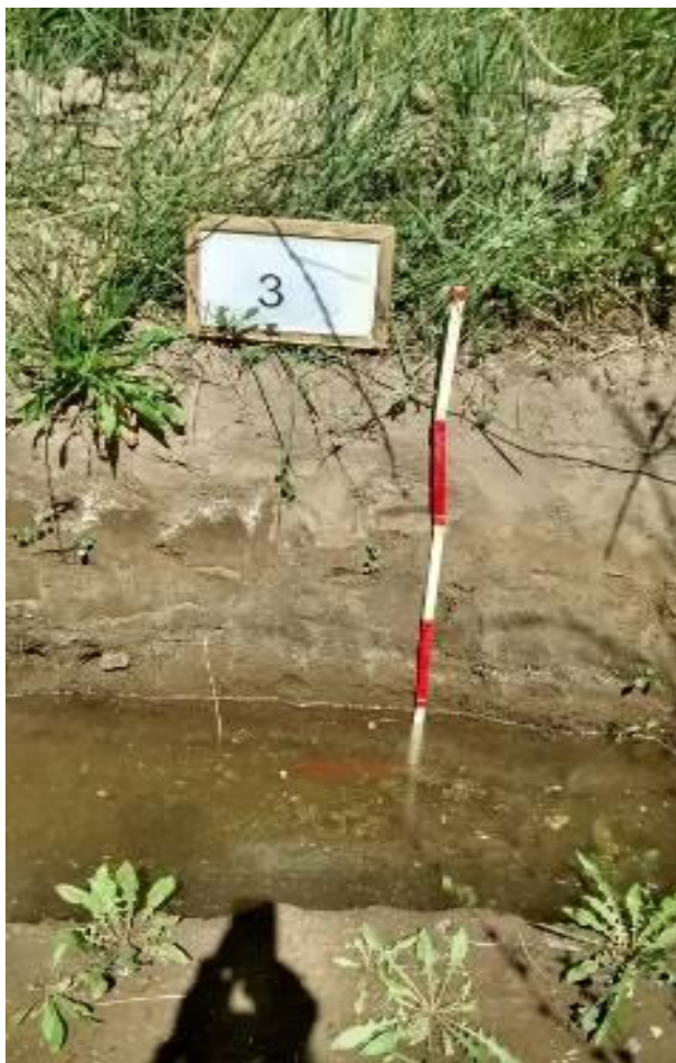
Figura 2: Calicata abierta con nivel freático a 0.48 m al inicio de la experiencia.
